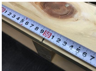
4 上板50cmに印を付け、真ん中の桁の芯と合わせて下さい。
