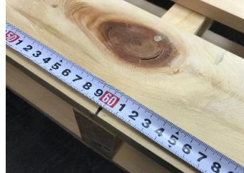
4 上板60cmに印を付け、真ん中の桁の芯と合わせて下さい。
