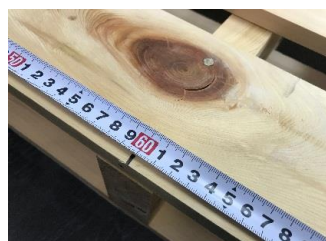
4 上板60cmに印を付け、真ん中の桁の芯と合わせて下さい。
