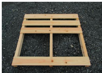
7 間に上板4枚を入れ、約5.6cm間隔で釘で止めて下さい。 (オプションで上板を追加した場合は、間に上板5枚を入れ、約2.5cm間隔で止めて下さい。)
