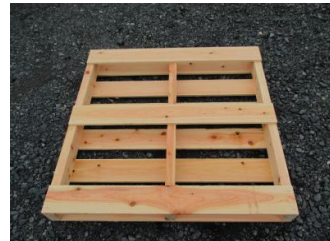
9 手前と奥の板の両端を釘で止めて下さい。
